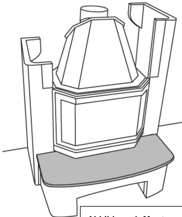
**Abbildung 4: Montage der Sockelplatte**
