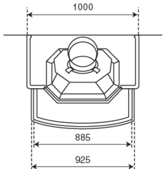
**Abbildung 8: Abmessungen**
