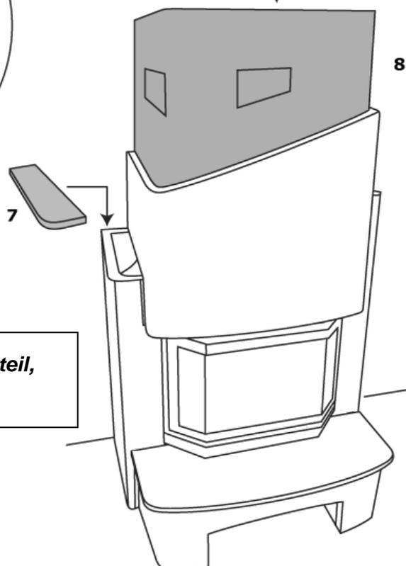
**Abbildung 6: Montage der Kaminhaube Oberteil, der Abdeckung und des Luftgitter**
