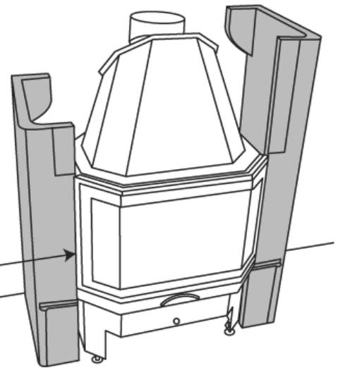
**Abbildung 3: Montage des Sockel und der Sockelblende**
