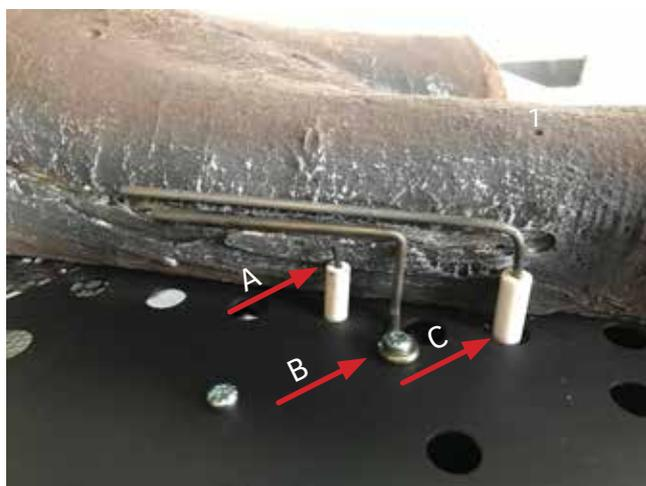
Abb.:28 Detail Keramik-Holzscheite 1 mit Position der Zündung (A), Erdung (B) und Ionisation (C)
