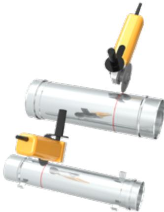
3) Rohrteile mit Hilfe eines Trennschleifers o. Ä. durchtrennen.
