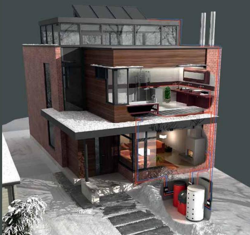
Schnittmodell einer in ein Heizsystem integrierten wassergeführten Brennzelle
