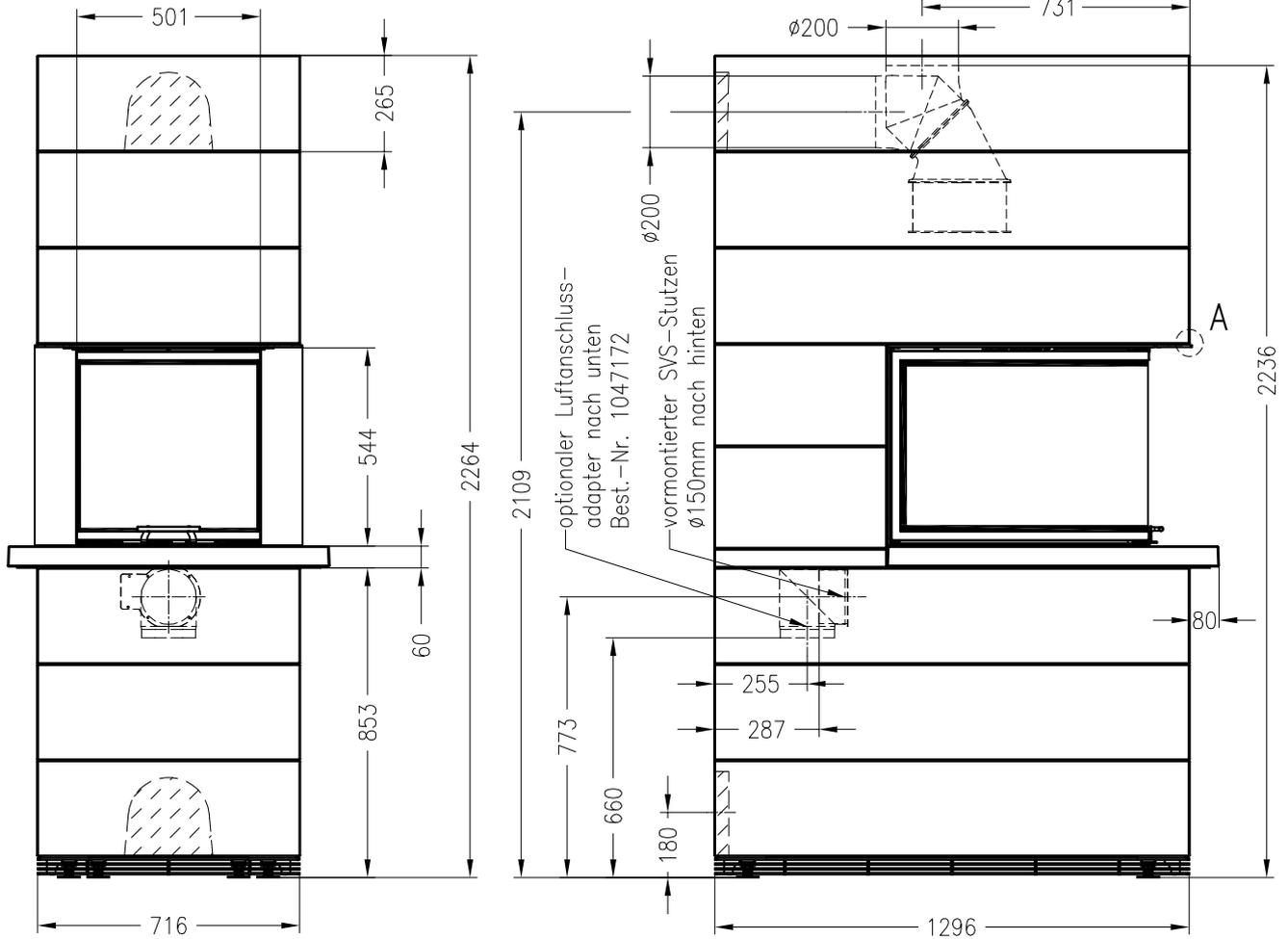
in Betonelement zu erstellender Ausbruch für Abgas- und optionalen Verbrennungsluftanschluss hinten
