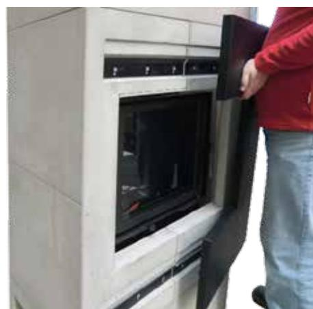
19. Frontplatten rechts und links parallel schräg von oben zur Anlage einhängen...
