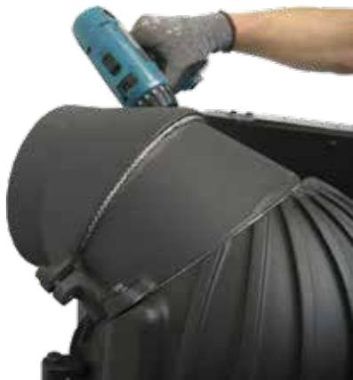
9. Abgaskuppel für hinteren oder oberen Anschluss montieren.
