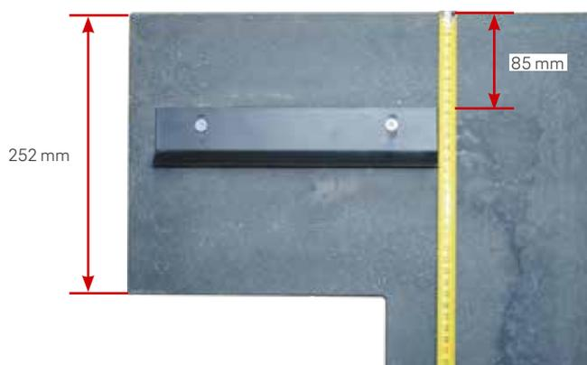
17. Oberen Haltewinkel von Oberkante Frontplatte im Abstand von 85 mm mit Senkkopfschraube M 6x 12 mm rückseitig montieren.
