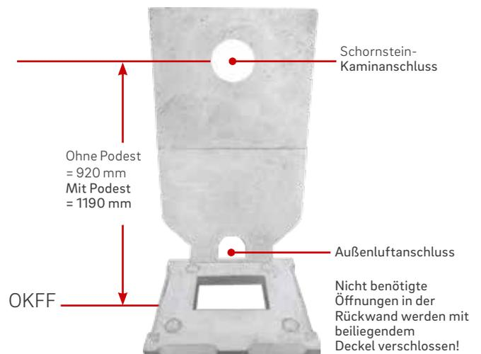
6. Jetzt die hinteren Anschlüsse (beim waagerechten Kaminanschluss) an der Zimmerwand anzeichnen (Rückwände zur Seite legen) und bohren. Abgasstutzen Ø 150 mm: Anschlusshöhe ab Oberkante Fertigfußboden (OKFF) bis Mitte Rohr = **920 mm ohne Podest oder 1190 mm mit Podest.**
