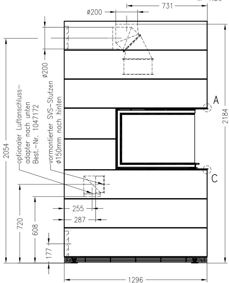
in Betonelement zu erstellender Ausbruch für Abgas- und optionalen Verbrennungsluftanschluss hinten
