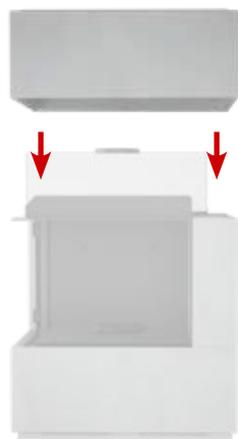
19. Erstes Oberbauteil **ohne zu Verkleben** von oben auf die Seitenteile setzen.
