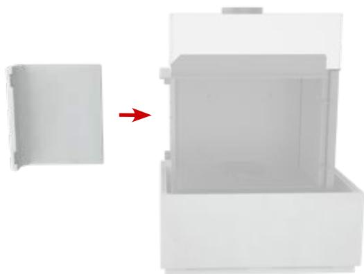
17. Seitenteil (mit integrierter Hinterlüftung) ohne zu verkleben von oben mit der Sichtseite außen bündig auf das Unterbauteil setzen Hinterlüftung zur Wandseite.
