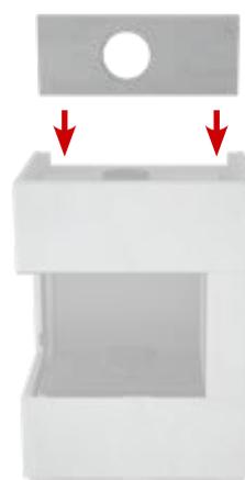
20. Oberes Rückwandmodul (mit Hinterlüftung zur Wandseite) in das Oberbauteil setzen.
