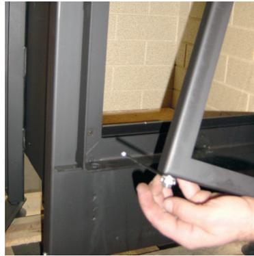
5. Zum Einsetzen der Tür den Spannschlüssel mit dem Griff nach außen am Scharnierring ansetzen (ca. 180° nach links – bei Linksanschlag)
