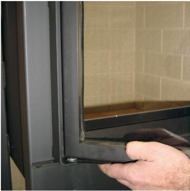
2. Den Spannschlüssel an den Federkopf aufstecken, so dass der Spannschlüsselgriff am Türrahmen festgehalten werden kann. Ggf. mit dem Spannschlüssel den Scharnierring leicht zum Kamineinsatz drücken um Verankerungen zu lockern.
