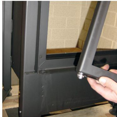
6. Anschließend den Spannschlüssel ca. 180° zum Türflügel (nach rechts – bei Linksanschlag) drehen und festhalten. Erst dann den Türflügel in das obere Scharnier und dann unten wieder einhängen.
