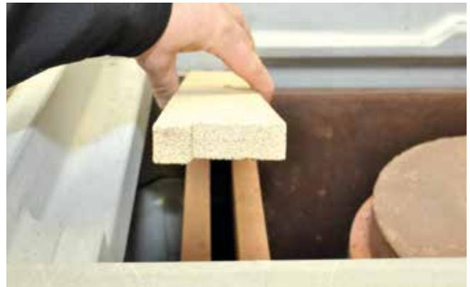
10. Abdeckleisten (aus Vermiculite) bitte auf beiden Schamotteguss-Innenwänden Wandseite und vorne auflegen.
