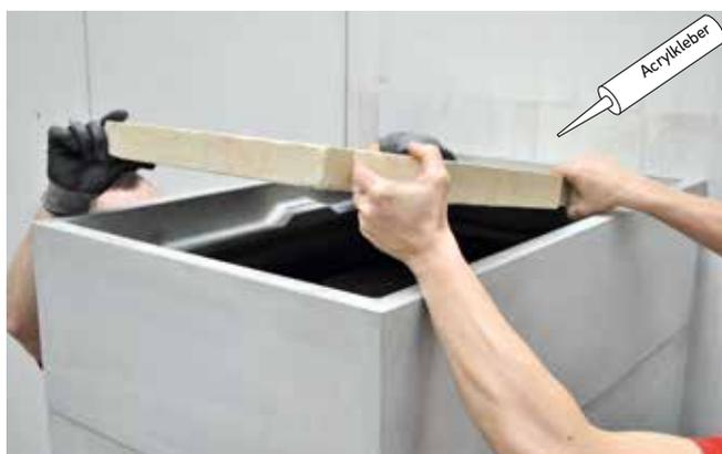
14. Alle Teile mit Acrylkleber neu setzen und die Innen-Deckenplatte (5cm Vermiculite) von oben in die Anlage einlegen.
