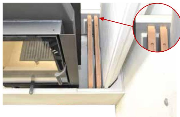
10. Die unteren zwei Schamottegussplatten Höhe 200mm (zur Wandseite) in die vorgesehenen Führungsrippen der Unterbauteile setzen (Falzseite der Platten zeigt zur Wand).
