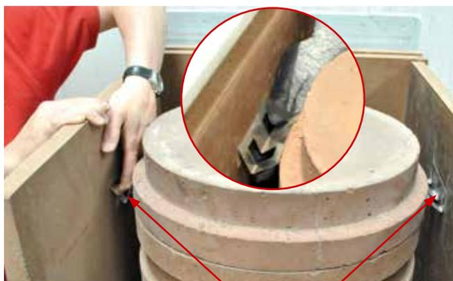
9. Zur Fixierung der beiden Schamotteplatten werden auf beiden Seiten zwischen Schamottering und Schamotteplatte von oben jeweils zwei Edelstahlhaltefedern (oben und unten) eingedrückt..
