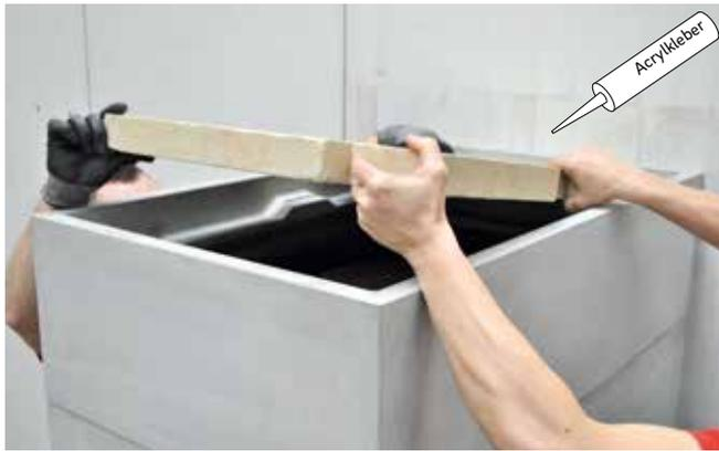
12. Alle Teile mit Acrykleber neu setzen und die Innen-Deckenplatte (5 cm Vermiculite) von oben in die Anlage einlegen.
