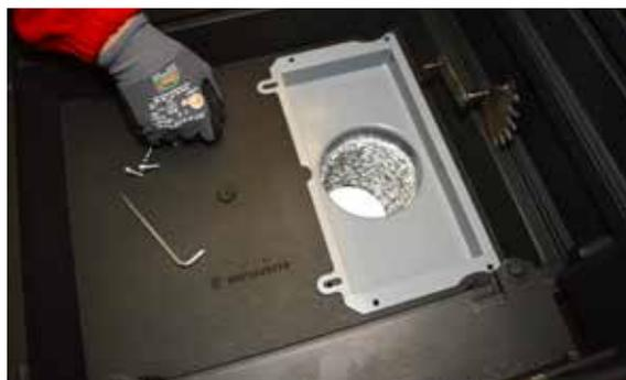
19. Legen Sie den Verbrennungsluftstutzen  $\varnothing$  125 mm mit dem montierten Flexschlauch ein.
