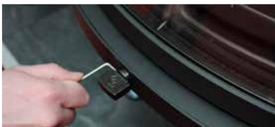
28. Setzen Sie den mitgelieferten Drehgriff waagrecht auf das herausstehende Ende der Welle und ziehen Sie den Gewindestift mit dem Innensechskantschlüssel 2,5 mm fest.
