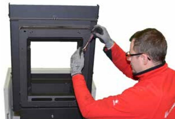
9. Adapterrahmen mit vier Innensechskantschrauben befestigen.
