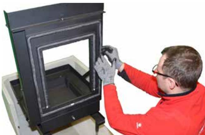
8. Schnurdichtung außen einkleben (lange Schnurdichtung).
