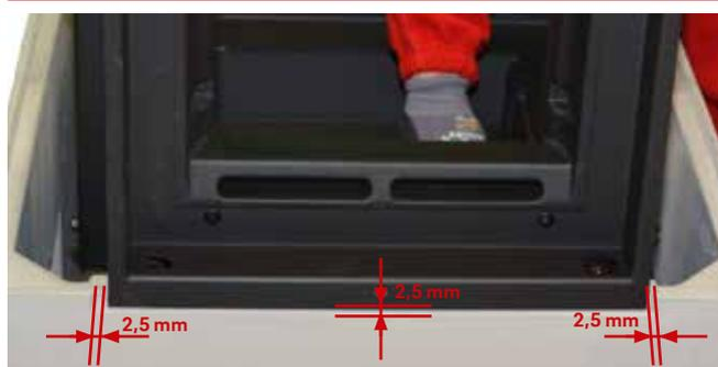
14. Den Grundkorpus jetzt zurückschieben bis die Türzarge am Unterbauteil anliegt. Die Frontzarge ist in die Anlage eingelassen, daher den Grundkorpus genau ausrichten!
