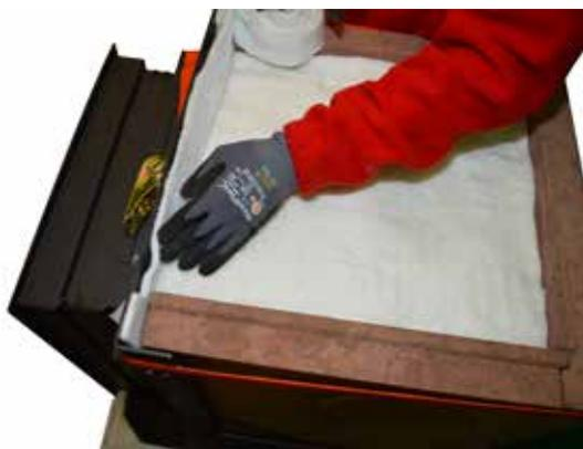
50. Abdeckvlies auflegen und vorderen Dichtungsvlies-Streifen hinter die Vorderwand drücken.
