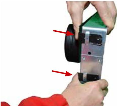
71. Zunächst wird das Stutzenblech in den Einbaurahmen gedrückt.
