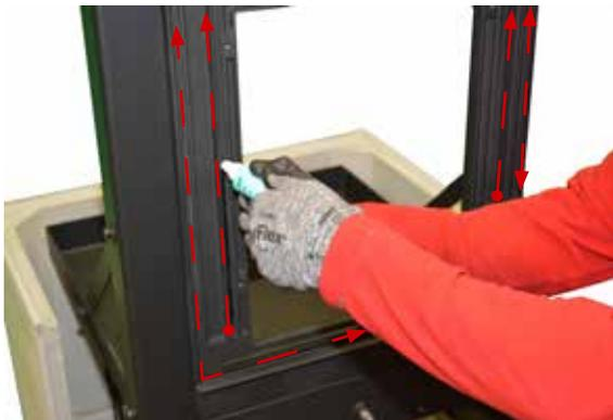
6. Kleber durchgehend dünn in die Führungsnuten für die Dichtschnüre auftragen (äußere Führungsnut umlaufend!).
