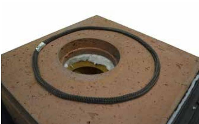
54. Dichtschnur in die Nut der Abdeckplatte einlegen.
