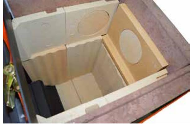
47. Die oberen Seitensteine mit Verschlußdeckel setzen.
