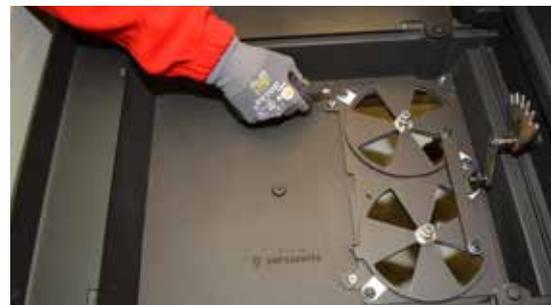
17. Schrauben Sie am Drehschieber die vier Schrauben am Boden ab und entnehmen Sie den Drehschieber.
