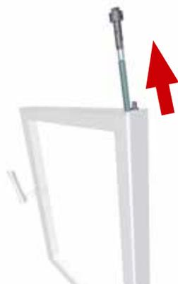
5. Türfeder Bauart A1 und Türanschlagstift mit Maulschlüssel SW 10 herausdrehen und entfernen.
