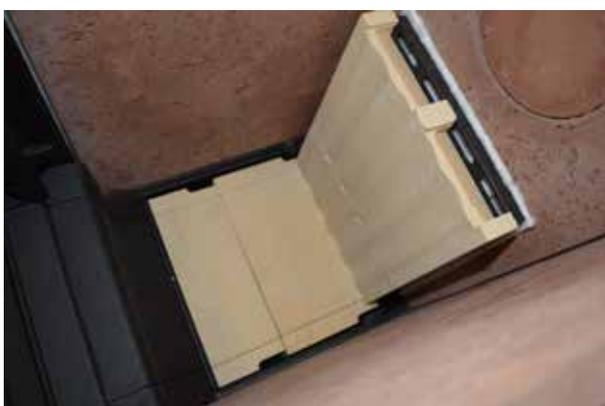
44. Rückwandsteine unten und Mitte vor den Sekundärluftkanal setzen.
