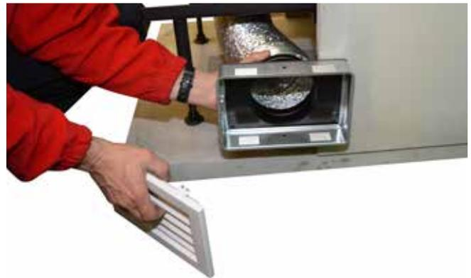
72. In den Unterbauteilen sind die Einbaupositionen rechts und links innen vorgeben. Bitte den Ausschnitt laut innenliegender Kontur genau für den Einbaurahmen ausschneiden. (Tipp: Stichsäge mit Diamantblatt verwenden und Schnittkanten ausßen abkleben). Aluflexschlauch anschliessen und Einbaurahmen montieren.
