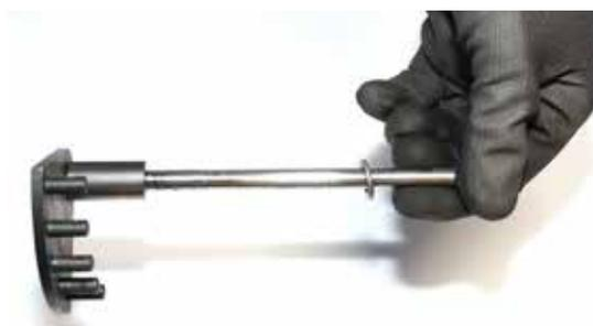
23. Bereiten Sie die obere Umlenkswelle vor. Schieben Sie eine Passscheibe 8/14/1 auf die Welle.
