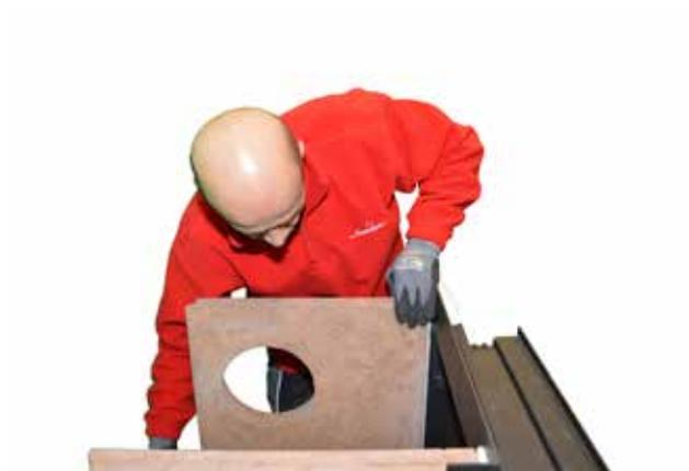
37. ... und rechts in den Grundkorpus setzen und mit dem Dichtungsvlies an den Rahmen schieben.
