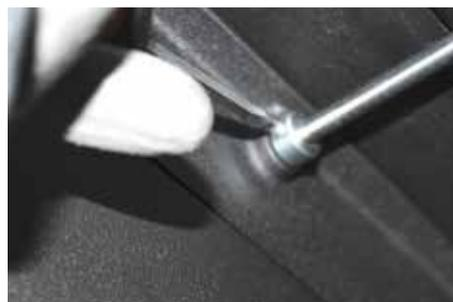
29. Schieben Sie an der oberen Umlenkswelle den Stellring bis zum Gehäuse des Grundofenes. Dabei ca. 0,5 mm Spiel zum Gehäuse lassen.
