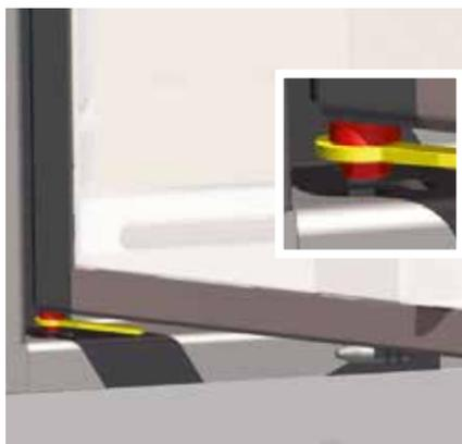
4. Tür mit Spannschlüssel nach oben drücken, bis der Bolzen aus der unteren Öffnung im Zargenrahmen austritt.
