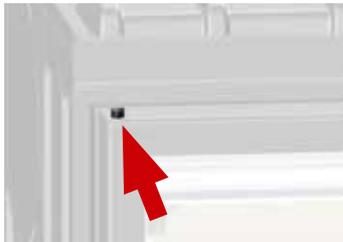
1. Sicherungsclip **75 M** mit Spitzzange abziehen.
