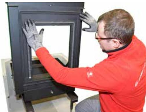
7. Schnurdichtung innen einkleben (kurze Schnurdichtung).
