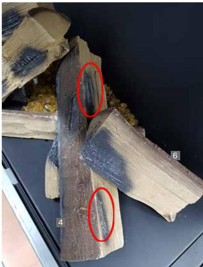
Abbildung 11: Detail Aufbau Schritt 4. Achten Sie darauf, den Holzsplit Nr. 6 mittig auf Holzsplit Nr. 4 zu positionieren. Die beiden Öffnungen für die Gasausströmung dürfen nicht verdeckt werden.
