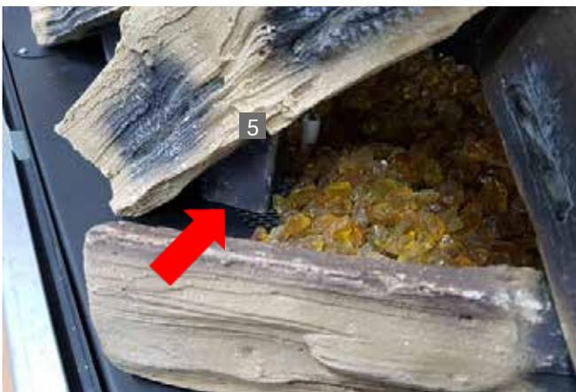
Abbildung 8: Detail Aufbau Schritt 3. Bitte beachten Sie, dass der Brennerfuß direkt auf dem Feuerraumboden aufliegt. Es darf sich kein weiteres Dekorationsmaterial zwischen Brennerfuß und Feuerraumboden befinden.
