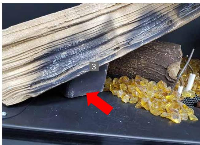
Abbildung 5: Detail Aufbau Schritt 2. Bitte beachten Sie, dass der Brennerfuß direkt auf dem Feuerraumboden aufliegt. Es darf sich kein weiteres Dekorationsmaterial zwischen Brennerfuß und Feuerraumboden befinden.
