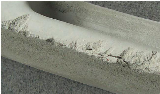
Die Speicherbetonverkleidung wird in der Herstellung mit einer Armierung versehen und hat daher eine sehr hohe Stabilität! Dennoch kann es beim Transport und der Montage zu oberflächlichen Abplatzungen kommen. Diese Mängel können mit der mitgelieferten Spachtelmasse repariert werden.
