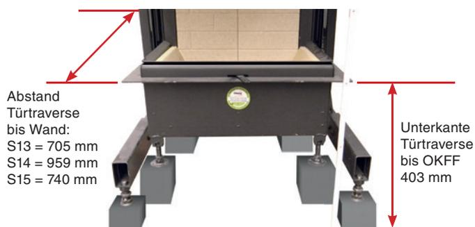
1. Das Tragrahmensystem wird auf die Betonfüße (6 cm) gestellt und um den Einsatz montiert (siehe zus. Anleitung). Abstand von Unterkante Tragrahmen bis OKFF = 918 mm. Bitte den Tragrahmen vorne ca. 5 mm vorspannen und ausrichten.
