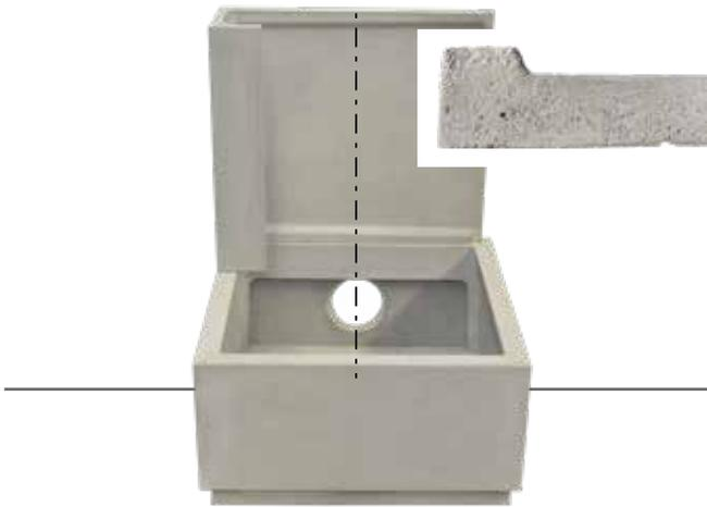
4. Seitenteil (mit integrierter Hinterlüftung) mit der Sichtseite außen bündig auf das Unterbauteil setzen! Hinterlüftung zur Wandseite!
