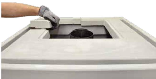
17. Deckenplatte hinten, rechts, links und vorne einsetzen.
