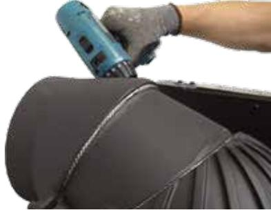
1. Abgaskuppel für waagerechten oder senkrechten Anschluss montieren.
