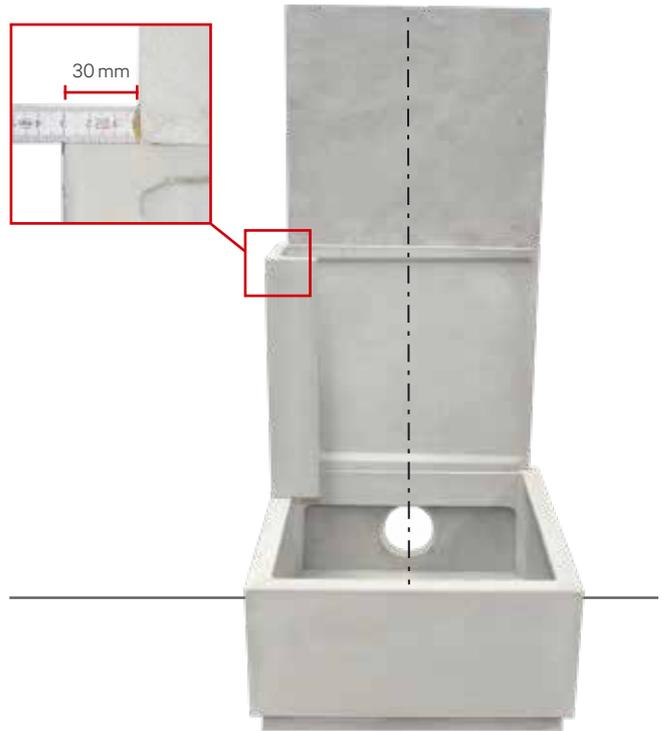
5. Jetzt die obere Rückwand (mit 30 mm Versatz zur Außenkante vom Seitenteil) auf das Seitenteil setzen. Alle Bauteile genau ausrichten.
