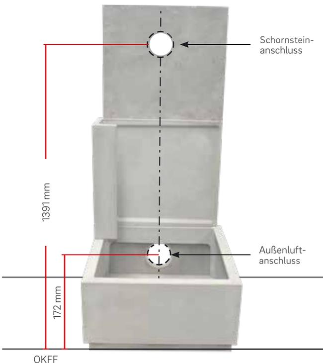
6. Jetzt die hinteren Anschlüsse (beim waagerechten Kaminanschluss) an der Zimmerwand anzeichnen (Rückwände zur Seite legen) und bohren.
