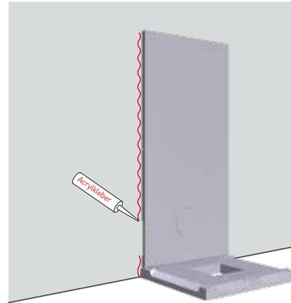
13. Anlage zurückbauen und alle Teile mit Acrykleber neu setzen. Die Rückwände wie abgebildet mit der Zimmerwand verkleben.
