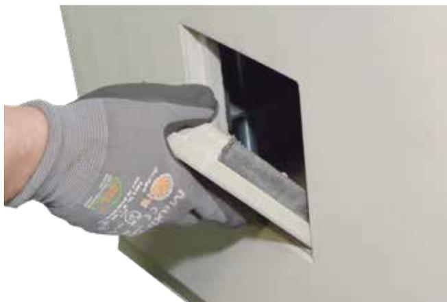
16. Revisionsdeckel schräg von oben in die Öffnung und vor die inneren Anschläge drücken. Zur Demontage der Deckel bitte nur im unteren Bereich auf den Deckel drücken.
