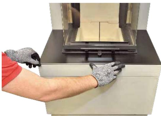
16. Bankplatte aus Stahl auf die Bank setzen, unter die Traverse schieben und ausrichten.
