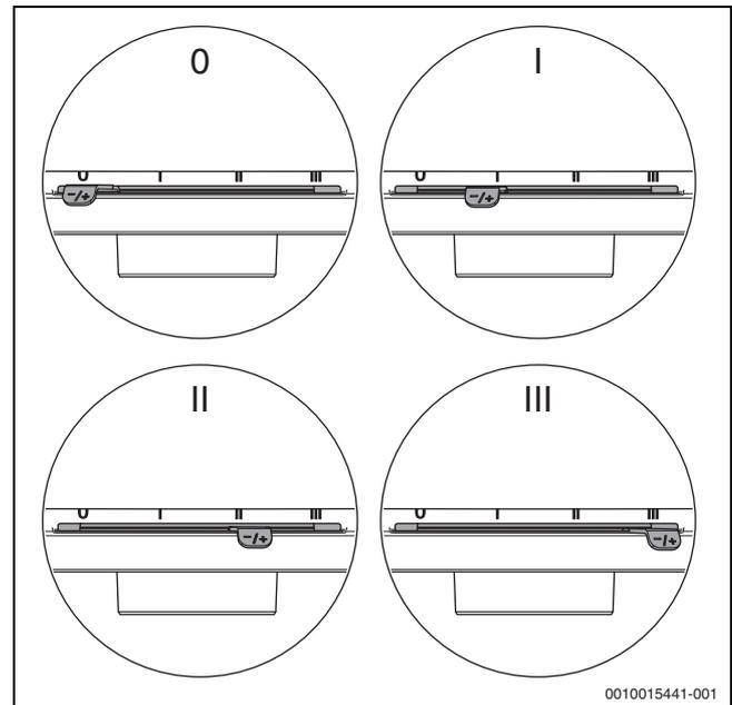
Bild 8 Verbrennungsluftschieber regulieren
