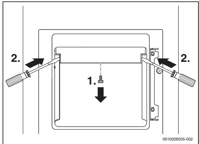
Bild 11 Sicherungsschraube entfernen und Isolierstein nach hinten drücken
