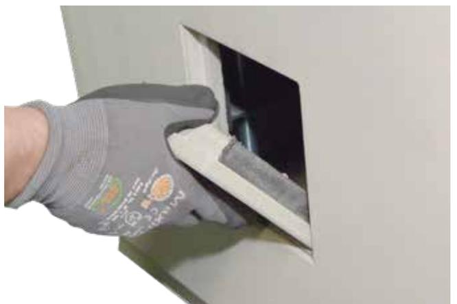
27. Revisionsdeckel schräg von oben in die Öffnung und vor die inneren Anschläge drücken. Zur Demontage der Deckel bitte nur im unteren Bereich auf den Deckel drücken.
